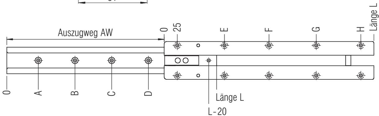
Anschraubbohrungen für 5 mm Spax-Schraube / M6 Senkkopf-Schraube
