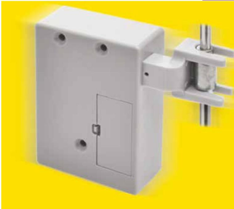
Die Mechanik des Elektronikschlösses wird berührungslos mit einem passiven Transponder betätigt. Die Stromversorgung erfolgt über eine handelsübliche 3V Lithiumbatterie die ca. 20.000 Schließvorgänge ermöglicht bevor das Schloss die erforderliche Auswechslung signalisiert. Wird das Auswechslungssignal überhört, öffnet das Schloss und bleibt geöffnet bis die Batterie ausgetauscht wird. Auf ein Schloss können bis zu 50 Transponder programmiert und auch jederzeit wieder gelöscht werden.
