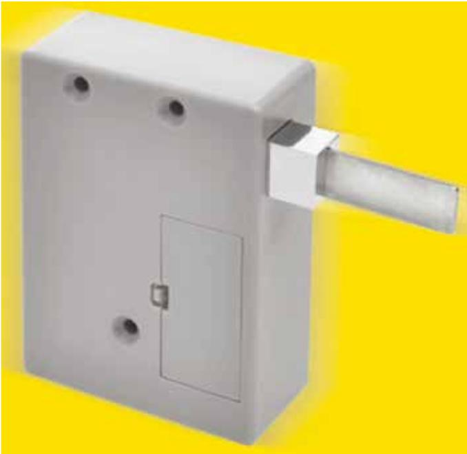
Die Mechanik des Elektronikschlösses wird berührungslos mit einem passiven Transponder betätigt. Die Stromversorgung erfolgt über eine handelsübliche 3V Lithiumbatterie die ca. 20.000 Schließvorgänge ermöglicht bevor das Schloss die erforderliche Auswechslung signalisiert. Wird das Auswechslungssignal überhört, öffnet das Schloss und bleibt geöffnet bis die Batterie ausgetauscht wird. Auf ein Schloss können bis zu 50 Transponder programmiert und auch jederzeit wieder gelöscht werden.
