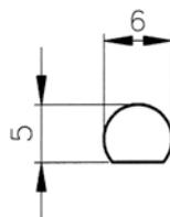
**Profilstange Ø 6 mm**
