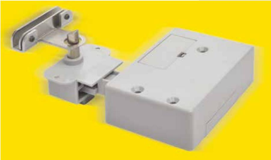
Die Mechanik des Elektronikschlosses wird berührungslos mit einem passiven Transponder betätigt. Die Stromversorgung erfolgt über eine handelsübliche 3V Lithiumbatterie die ca. 20.000 Schließvorgänge ermöglicht bevor das Schloss die erforderliche Auswechslung signalisiert. Wird das Auswechselsignal überhört, öffnet das Schloss und bleibt geöffnet bis die Batterie ausgetauscht wird. Auf ein Schloss können bis zu 50 Transponder programmiert und auch jederzeit wieder gelöscht werden.
