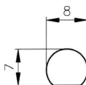
**Profilstange Ø 8 mm**
